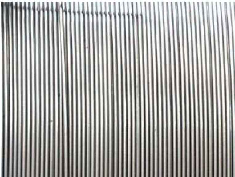
OK AristoRod üzerinde İlk küçük korozyon noktaları
